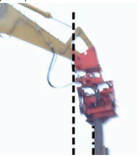
Рис. 5. Явление резонанса при работе.
