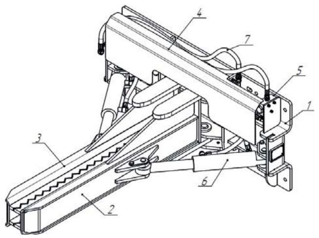
1 – Основание; 2 – Захват левый; 3 – Захват правый; 4 – Защитный экран; 5 – Делитель потока; 6 – Гидроцилиндр 2 шт.; 7 – комплект РВД.
