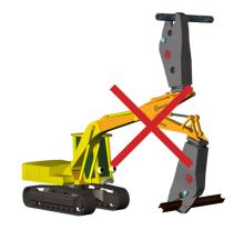
Не используйте инструмент для демонтажа, когда цилиндр ковша находится в крайнем положении!
