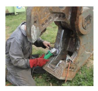
Несколько раз откройте и закройте челюсти гидроножниц для проверки смыкания режущих кромок. При необходимости повторите шлифование и закройте челюсть для проверки смыкания режущих кромок.
