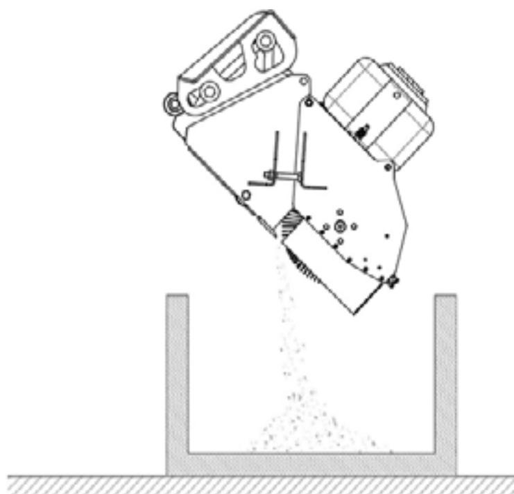
Рисунок 5 - Схема выгрузки мусора из бункера
