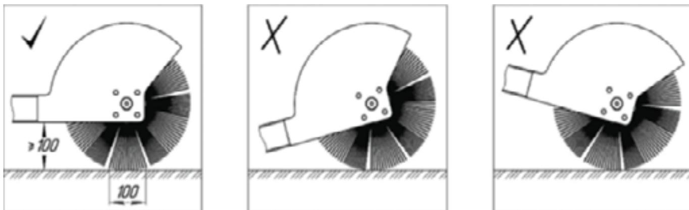
Рисунок 3 - Уровень наклона оборудования относительно земли
