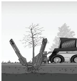
Выкопать пересаживаемое дерево. Для этого расположить машину в требуемом месте, опустить пересадчик деревьев на уровень земли, при этом все ножи должны находиться в верхнем положении. Последовательно заглубить ножи, после чего поднять стрелой машины вырезанный ком земли с деревом.
