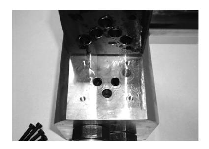
2. Соединить блок с гидромотором гидровращателя, равномерно попеременно (на пол-оборота за один раз) закручивая адаптеры по часовой стрелке.
